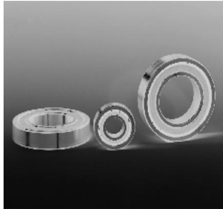
Laufbahnen der einreihigen Schrägkugellager sind so konstruiert, daß die Verbindungslinie ihrer Berührungspunkte mit Kugeln einen spitzen, sog. Druckwinkel bildet und sind unzerlegbar. Lager in Ausführung B und BE haben den Berührungswinkel  $\alpha = 40^\circ$ . Diese Konstruktion erlaubt dem Lager Radialbelastung aufzunehmen, die gleichzeitig mit relativ großer Axialbelastung in einer Richtung wirkt. Zur Axialbelastungsaufnahme in beiden Richtungen werden diese Lager in Paaren eingebaut.
